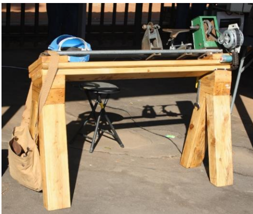
Een van die draaibanke wat deur Alan Crawford herbou is om dit rolstoelvriendelik te maak. / One of the lathes adapted by Alan Crawford for a wheelchair user.
