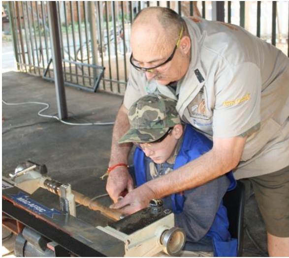
Johan Kramer van Spirit of Wood wys vir een van die seuns hoe om die kraal- en hollyste op 'n stoelpoot te sny. Die draaibank is vir 'n rolstoelgebruiker aangepas. / Johan Kramer from Spirit of Wood showing one of the students how to turn beads and covers on a chair leg. The lathe is wheelchair friendly.
